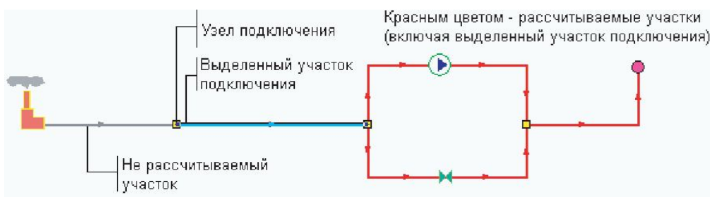
Рисунок 11.1- Раскраска сети для конструкторского расчета
